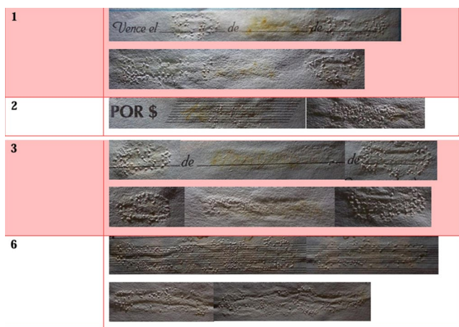
Figura 4. Formación de microburbujas en muestra de tinta negra líquida (Bic) tratada con hipoclorito de sodio (58%). Se aprecia una textura y distribución homogénea además de burbujas de mayor tamaño, que se pueden observar en cada renglón (enumerados en la columna lateral izquierda).
