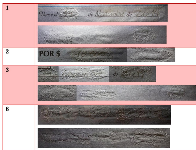
Figura 3. Formación de microburbujas en muestra de tinta negra pastosa (Bic) tratada con hipoclorito de sodio (58%). Se observa la textura superficial del papel y la distribución irregular de las burbujas según los renglones (enumerados en la columna lateral izquierda)
