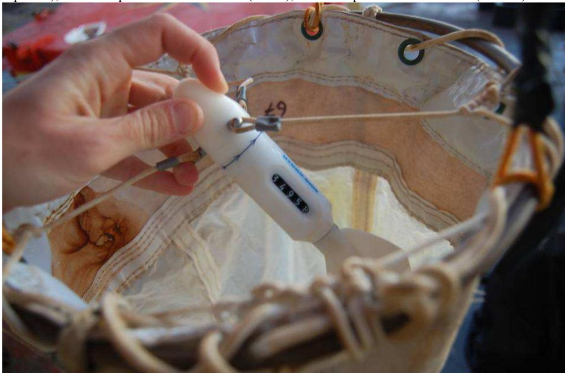
Figura 1.2. Detalle del flujómetro utilizado para las redes de zooplancton de 67 micras y de 220 micras.
