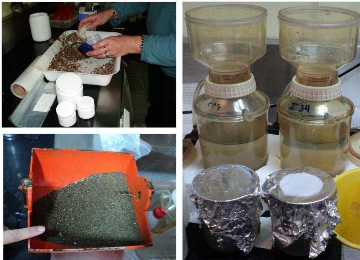
Separación y filtrado de los sedimentos
