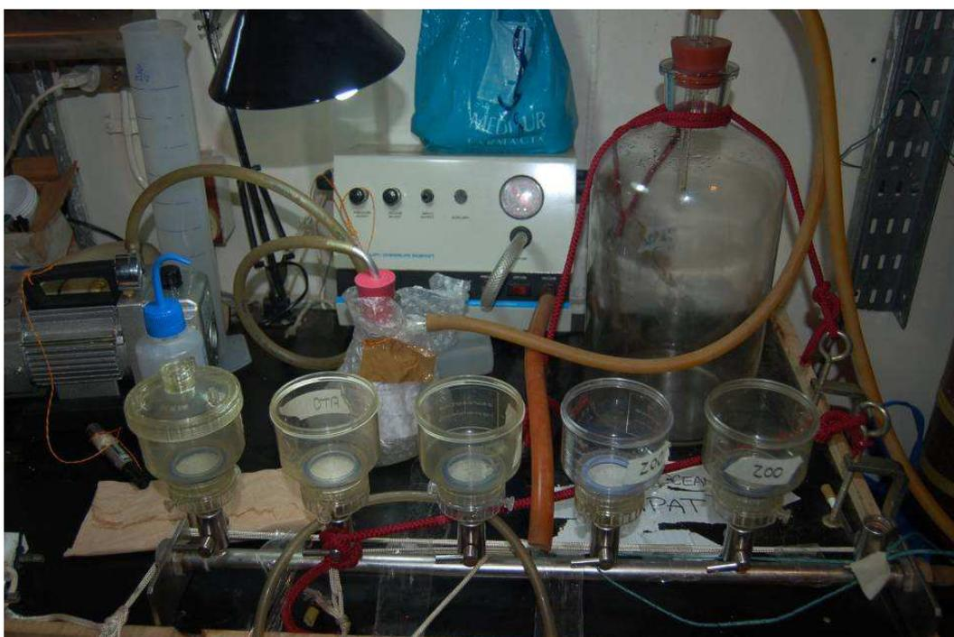
Figura 1.3. Sistema de manifold utilizado para filtración de las muestras de fitoplancton y zooplancton.
