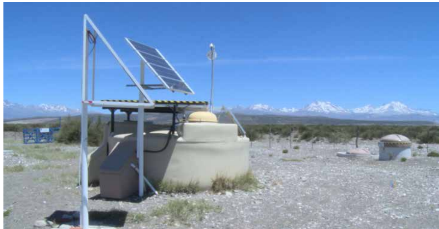
DETECTORES DE SUPERFICIE EN PLENA "PAMPA AMARILLA" EN MALARGÜE.
